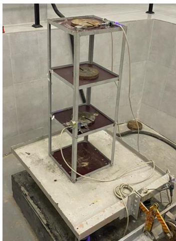
Рис. 1. Установленная модель на сейсмоплатформе
